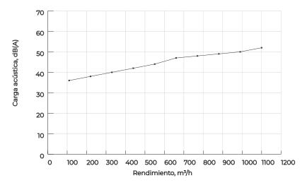
Nivel de presión sonora total en el sistema de ventilación PRANA-340S, a una distancia de 3 metros en modo «recuperación», dB(A).
