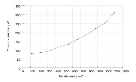
Consumo de energía del sistema de ventilación PRANA-340S en modo de recuperación, W.
